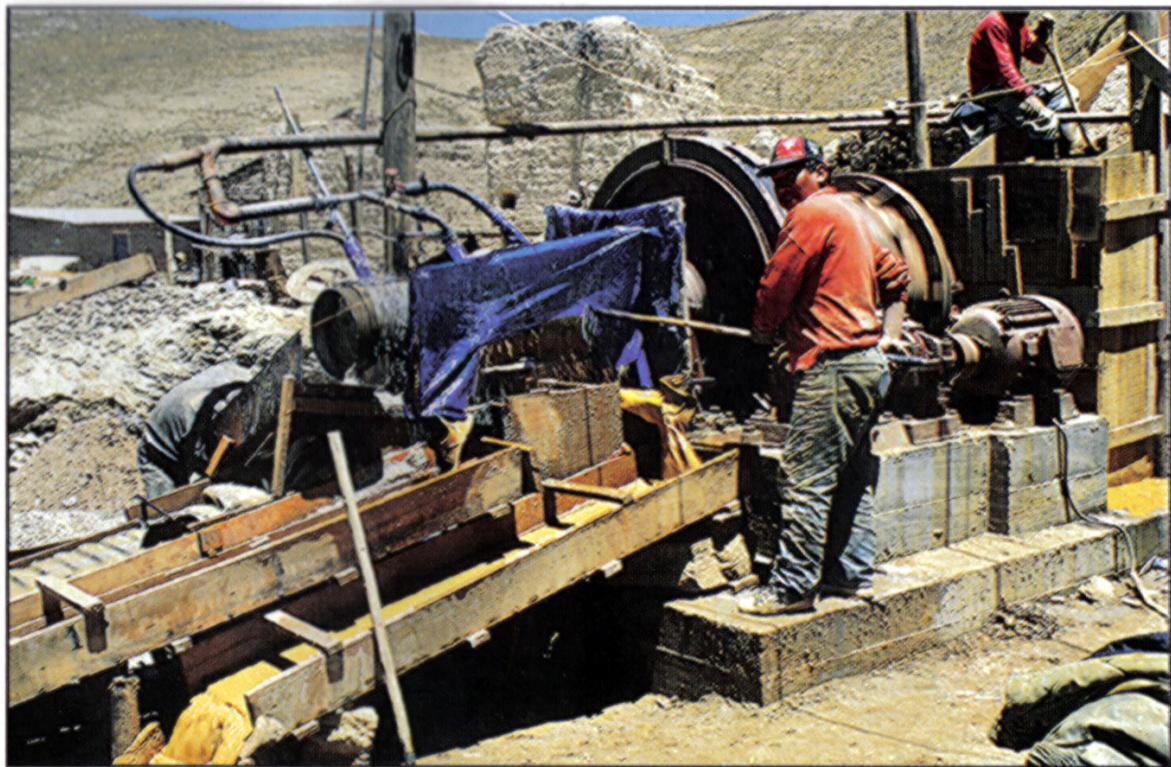
31. Canaletas con diferentes pisos (alfombras, metal expandido) para diferentes tamaños de carga clasificados por un tromel en la salida de un molino a bolas (Coop. La Libertad, Bolivia)
