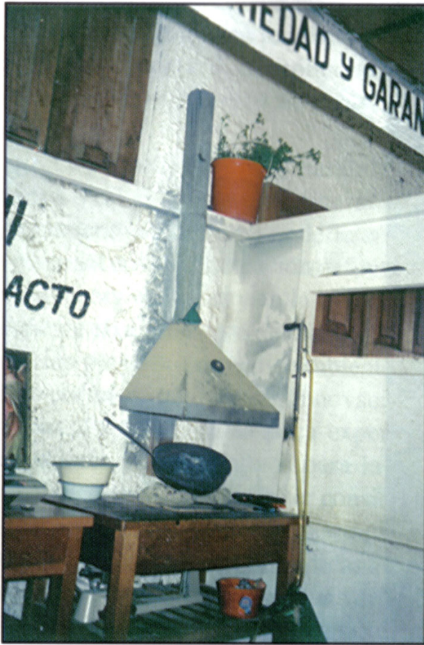
27. Campana para la quema de amalgama y fundición de oro dentro de una casa de compra de oro (Puerto Maldonado, Perú)
