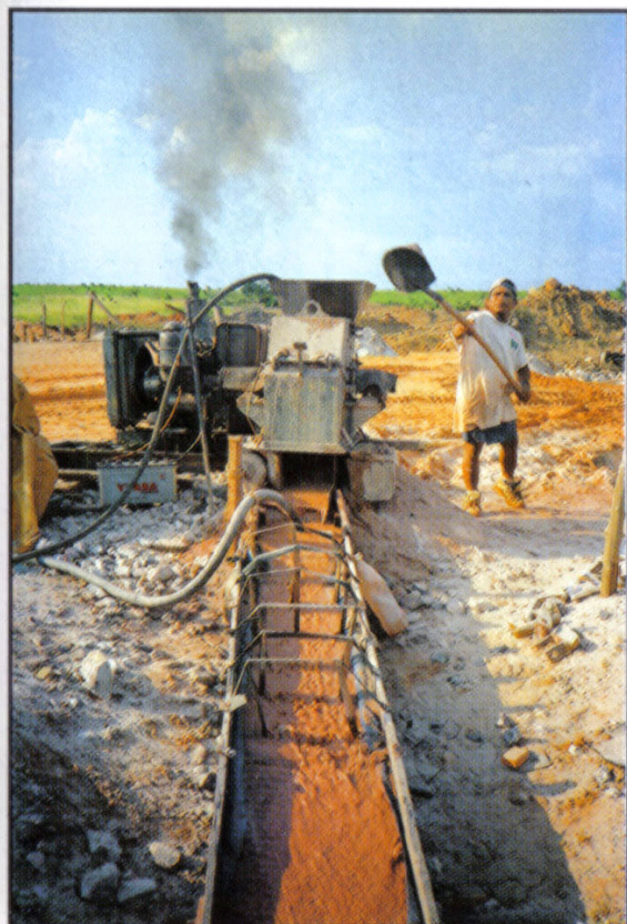
18. Molino a martillos con planchas amalgamadoras (San Simón, Bolivia)
