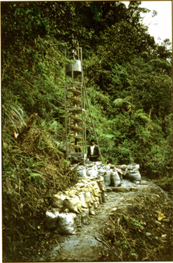
33. Concentrador espiral con su producción de dos semanas de piritas auríferas, que antes se descargó junto con las colas al río (Coop. Kantuta, Bolivia)
