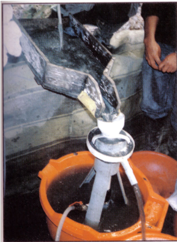
37. Separador hidráulico (Coop. Cotapata, Bolivia)
