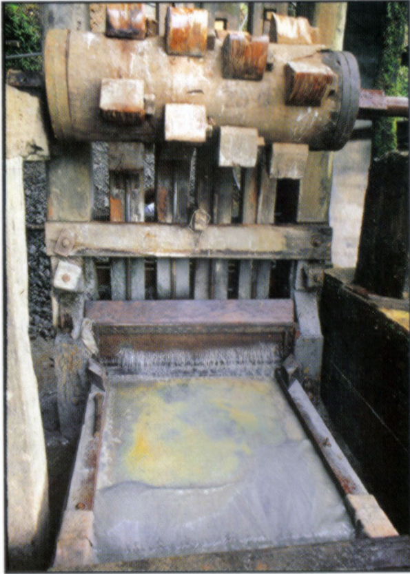
19. Molino a piones con planchas amalgamadoras (Mina Los Guavos, Nariño, Colombia)
