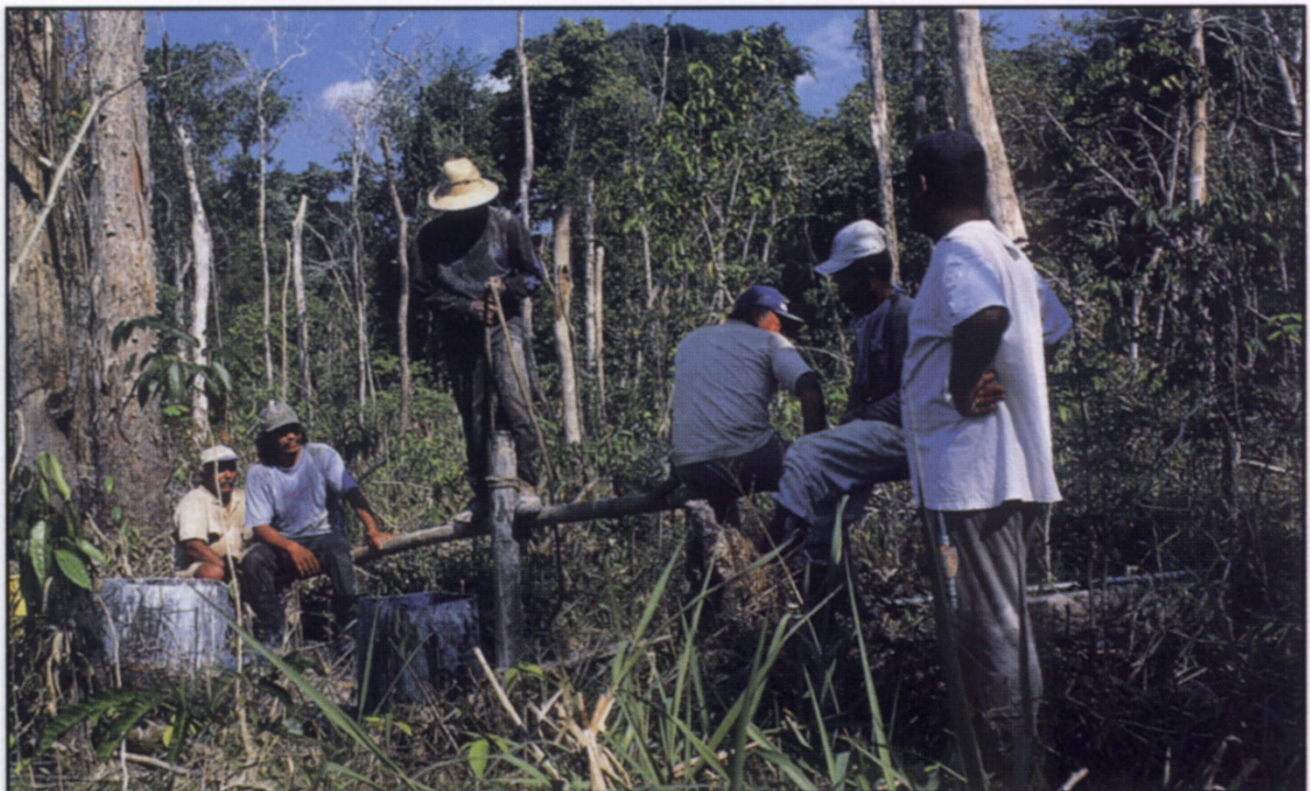
54. Perforación manual para la exploración de yacimientos aluviales (Tapajós, Brasil)
