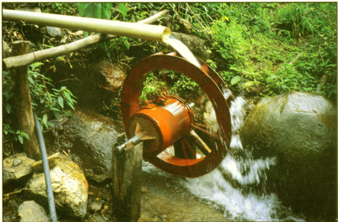
36. Tambor amalgamador con rueda de agua (Mina Los Guavos, Nariño, Colombia)
