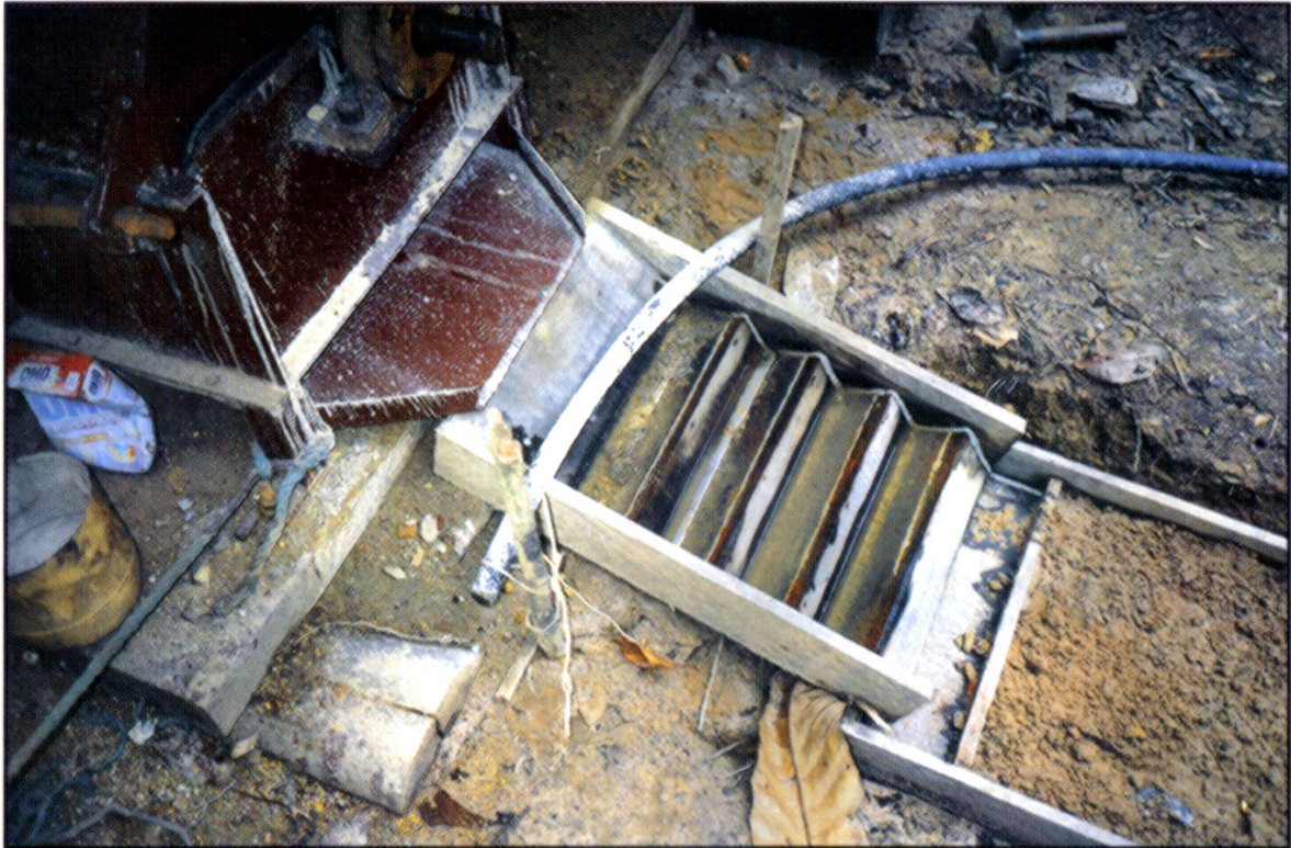
21. Amalgamador tipo "jackpot" después de molino a martillos (Cerro Azul, Tapajós, Brasil)
