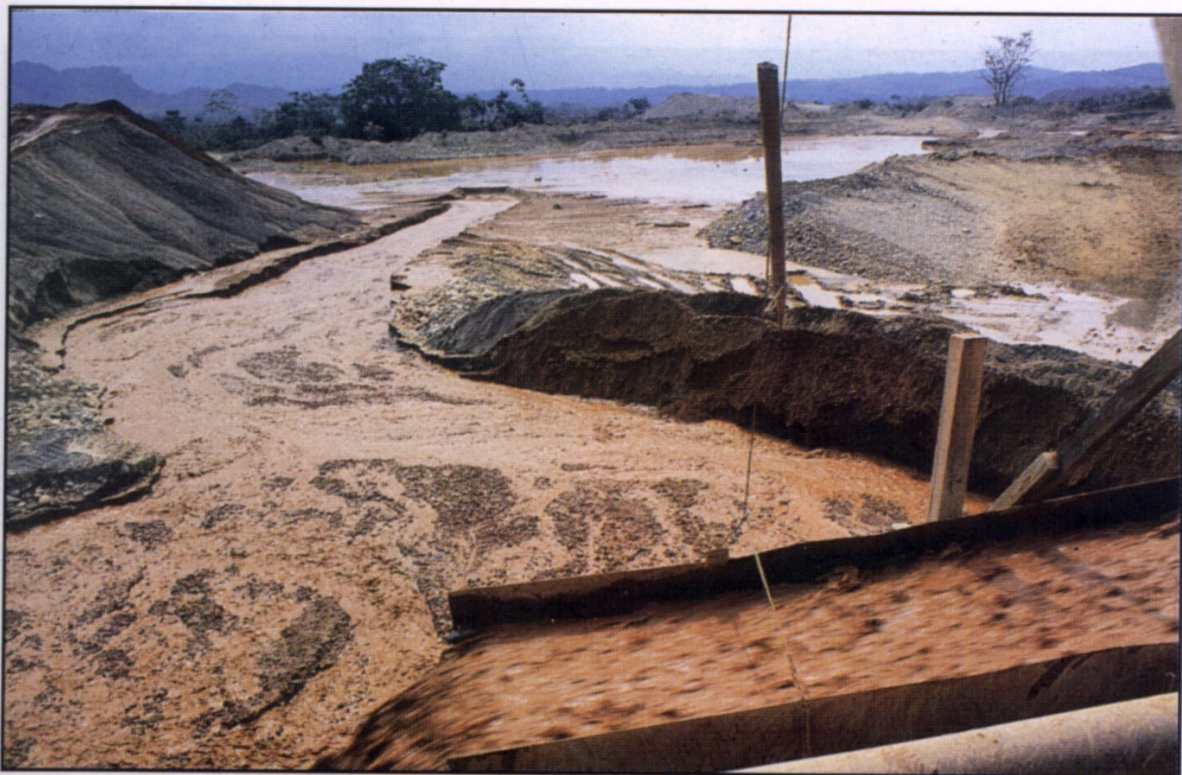
6. Minería aluvial: descarga de colas al río (Kabaketa, Colombia)
