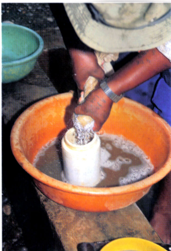
23. Exprimir el mercurio líquido de la amalgama manualmente por un trapo (Coop. Tupara, Bolivia)
