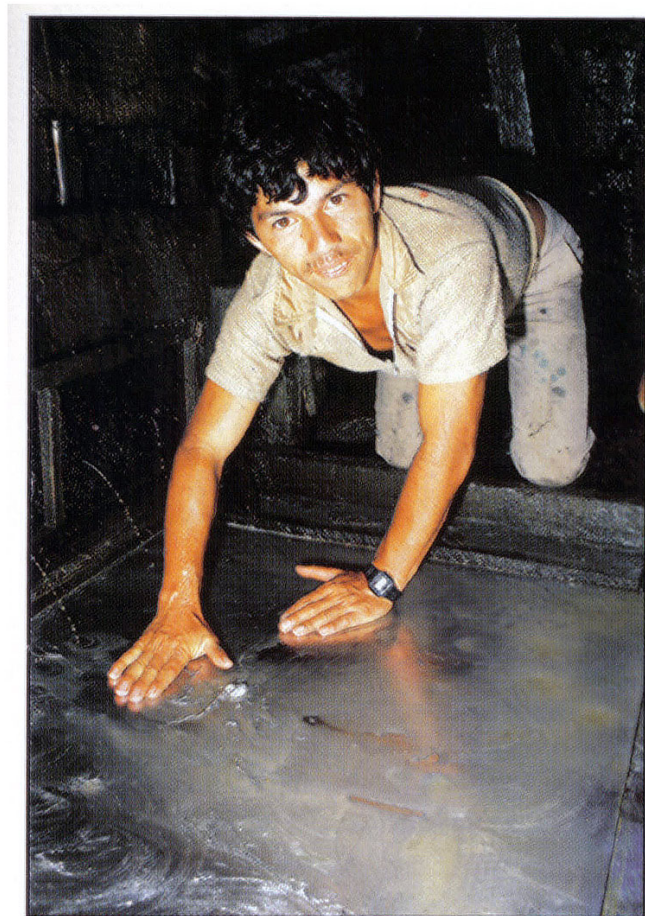
25. Preparación de planchas amalgamadoras (Nariño, Colombia)
