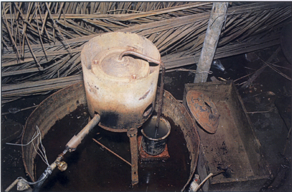
40. Retorta de fabricación industrial (brasileira)
