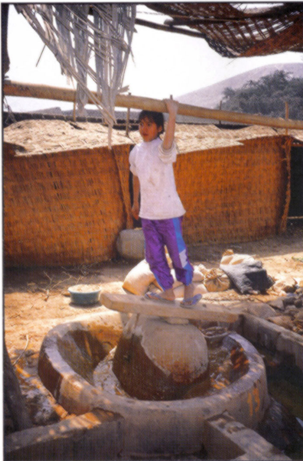
20. Molino/amalgamador de piedra (típicamente trabajo de niños o mujeres) (Nazca, Perú)
