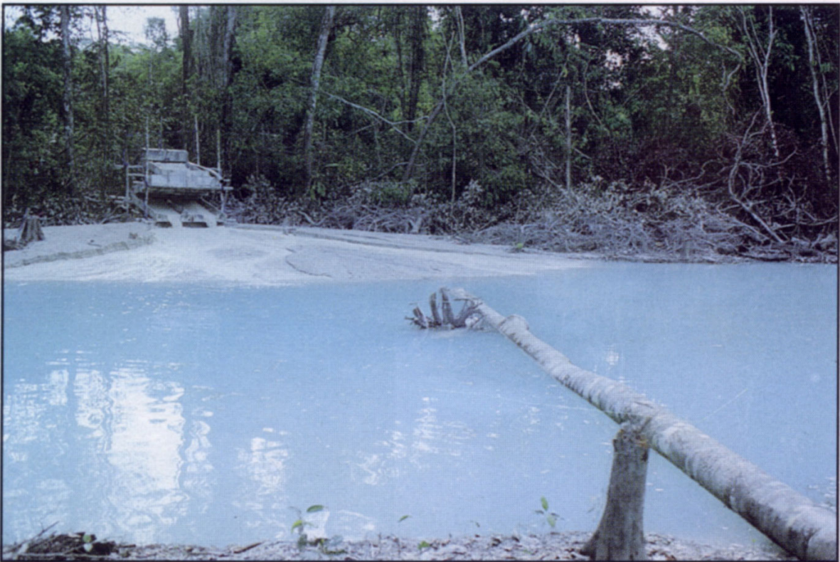
55. Relleno de barranco explotado con colas frescas (Piririma, Tapajós, Brasil)
