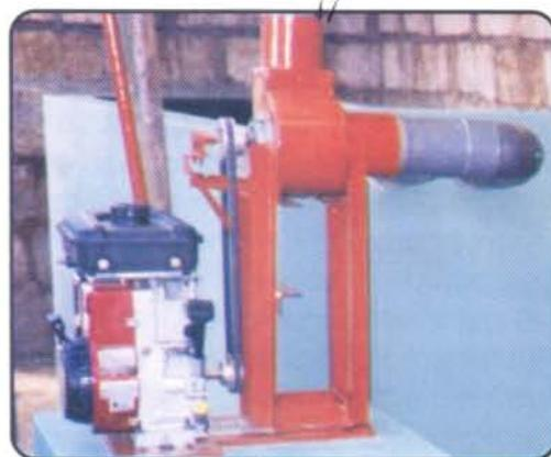
aluminio, un extractor hecho de aluminio tendrá muy poca vida útil. Por tanto, lo recomendable es encargar a un taller metal-mecánica, la fabricación de un extractor de acero. Por supuesto un extractor "casero" no tiene la misma fuerza que uno comercial, técnicamente diseñado; pero... ¡no se necesita que tenga mucha fuerza!
