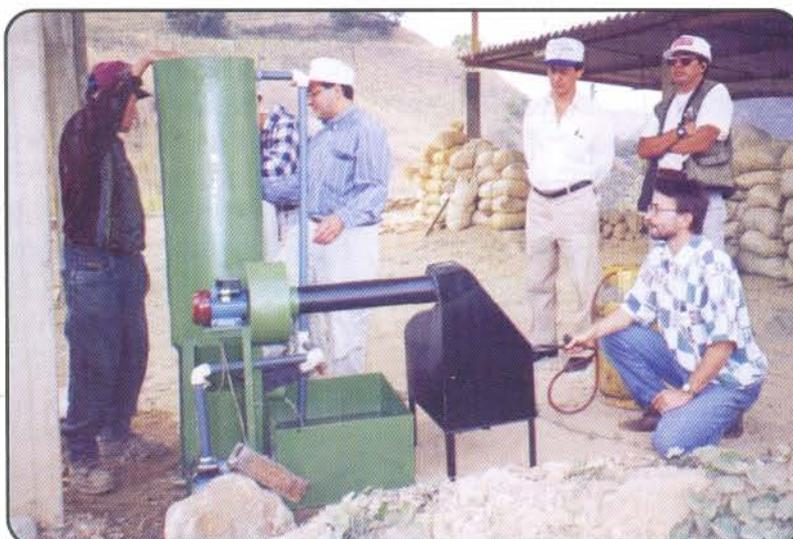
Asimismo resultó insuficiente la masa de grava (piedras duras sub redondeadas) para mantener una temperatura fría durante prolongadas quemas, (el equipo comenzó a calentarse causando la evaporación del mercurio recuperado), y se experimentó problemas con condensación prematura de mercurio en el ventilador trabajando a presión entre el horno y el condensador.
